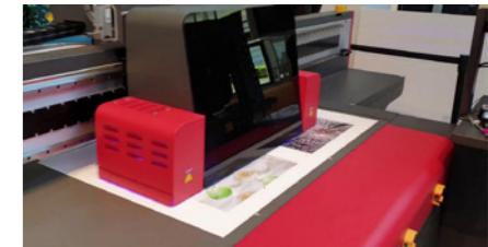
Karetki z precyzyjnym napędem liniowym
