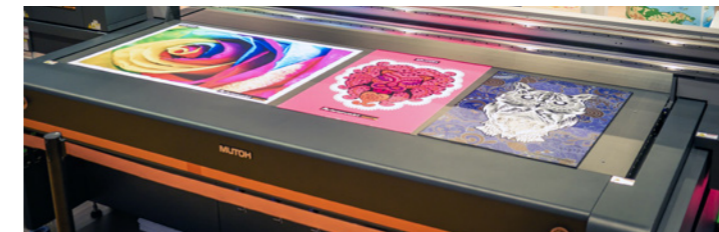
Stół z niezależnymi strefami podsusu i bolcami pozycjonującymi formatki
