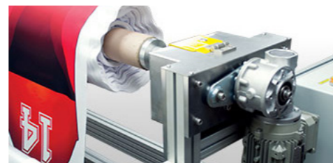
System korygujący przesunięcia materiału
